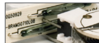
megaswitch® Tecnología de interruptor magnético megaswitch
